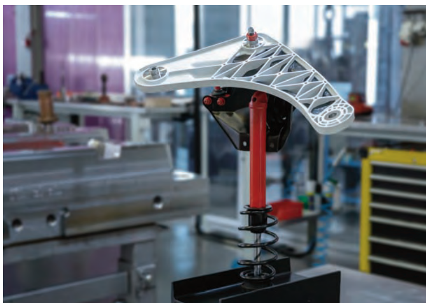
Figura 1 – Braço de suspensão reforçado com fibra de carbono unidirecional contínua de matriz termoplástica desenvolvido no projeto LaTCh II]
