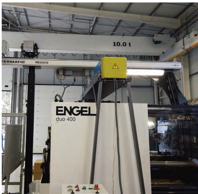
Figura 2 – Sistema produtivo – Robot, forno e ferramenta de estampagem e sobreinjeção
